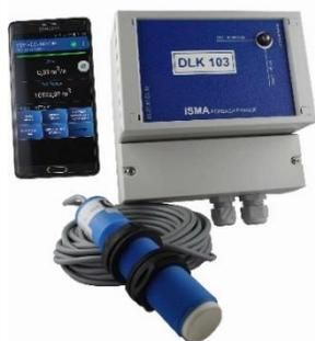
El DLK 103, es un dispositivo diseñado de acuerdo con nuestra experiencia en el campo. Es particularmente adecuado para calcular el flujo en obras del tipo de canal abierto, canal Venturi, vertedero en forma de V o en forma de U y cuchillas de desbordamiento. También permite medir alturas y tiempos de desbordamiento. Ha sido diseñado para:
