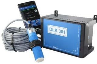
El DLK 301, es un dispositivo diseñado para el cálculo del flujo en obras del tipo de canal Venturi, vertedero en V o en U y cuchillas de desbordamiento.
